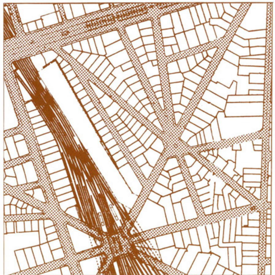
L'organisation du quartier de l'Europe (l'un des grands lotissements de la Restauration avec les Batignolles, Passy et Beaugrenelle) a été conçue suivant un réseau en étoile découpant l'espace en îlots triangulaires très caractéristiques de l'urbanisme du Paris du XIX e siècle.
